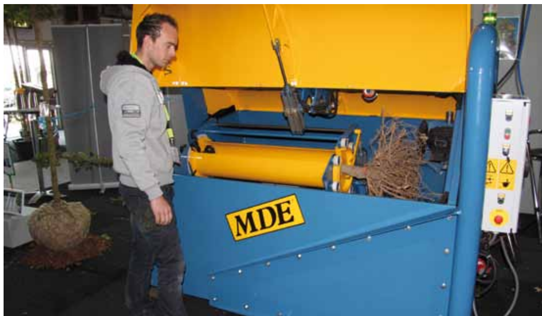
Wortelsnoeimachine van MDE Machinebouw.
