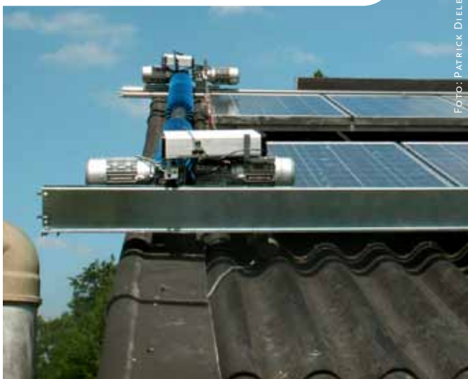
Bij Rudy Bayens worden 2 types van hetzelfde reinigingssysteem getest. Foto boven: rechts het systeem met één motor. Foto onder: de tweemotorige versie.
