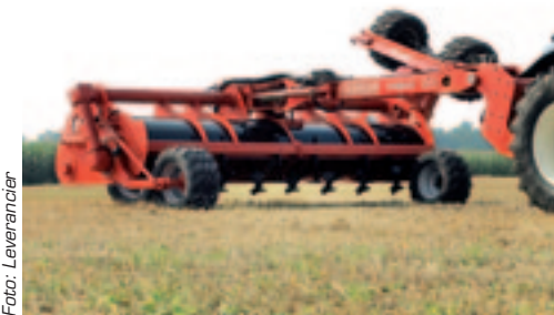
▲ De 6 meter brede Farmax-spitmachine. De machine wordt in de lengte getransporteerd.
