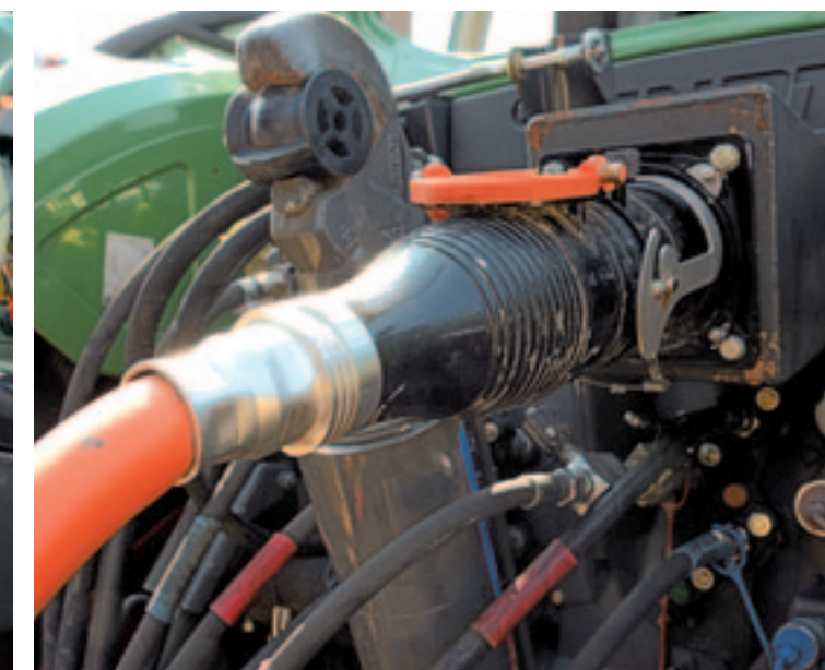
▲ Achterop de trekker kan de stroom via een grote stekker worden afgenomen door een werktuig.
