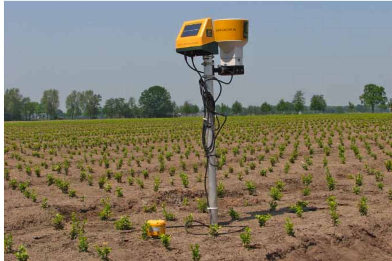
Bij TerraSen meet een sensor per 10 cm diepte het bodemvochtgehalte, en er is een regenmeter aan gekoppeld. Meetgegevens worden 'wireless' ofwel draadloos naar een computer gestuurd.
