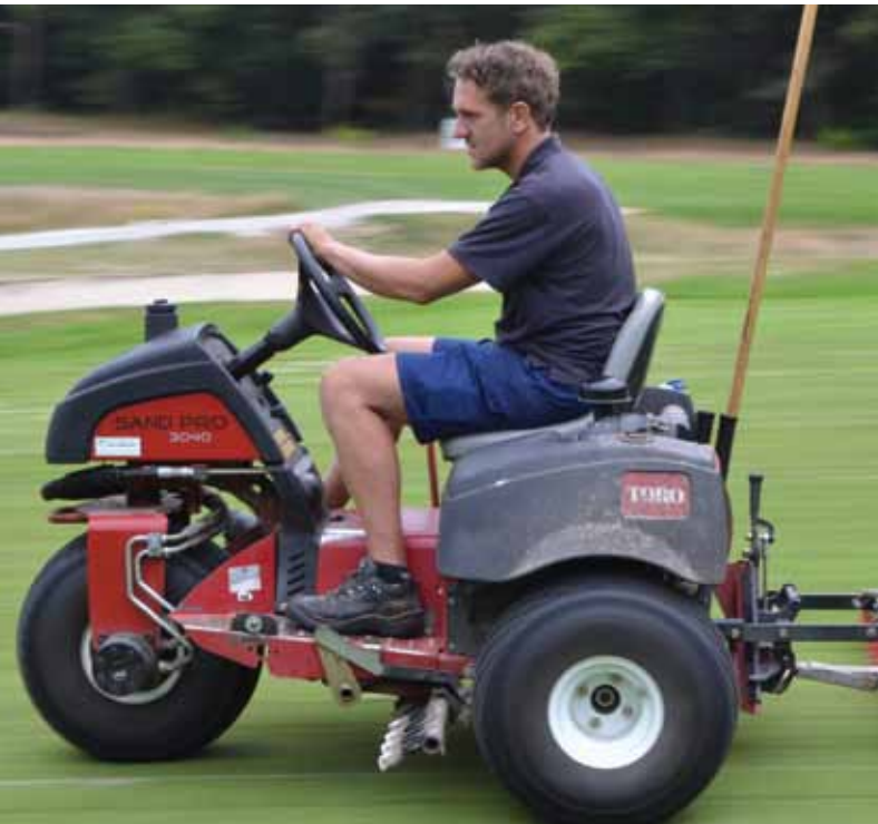
Zand en de gestrooide Vulcamin in de sleuften vegen.
