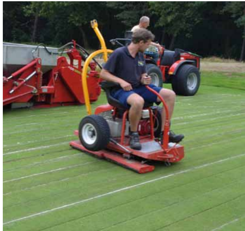
Tweemaal in de lengterichting rollen.
