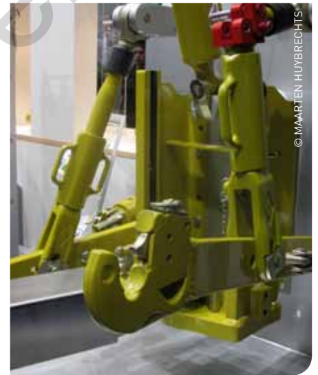
Hangen de onderdelen van de lift in de weg? Walterscheid heeft er een oplossing voor met deze knikbare hefstaaf.
