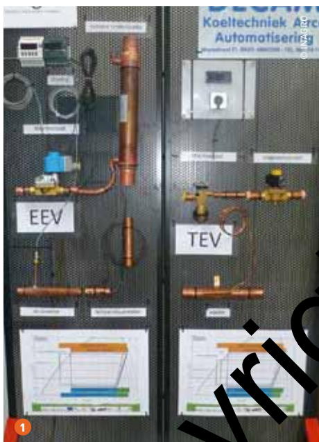
1 Een thermostatisch (links) versus elektronisch (rechts) expansieventiel. 2 Meten is weten. Met enkele eenvoudige en relatief goedkope urentellers kan de werking van een koelinstallatie goed opgevolgd worden.
