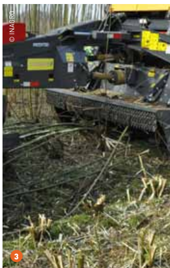
De 'stoppel' die de oogstmachine achterlaat heeft minder belang bij wilg, maar wel bij soorten die gevoeliger zijn voor rot. De Stemster 1 en New Holland 2 laten duidelijk de mooiste snoeiwonden na. Bij de Biobaler 3 en de Energy Harvester 4 is dit een minder goede eigenschap.
