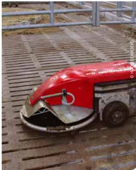
Een mestrobot van het merk Lely type 90 SW zorgt voor de reiniging van de roostervloer die gedeeltelijk uit ecoroosters bestaat.
