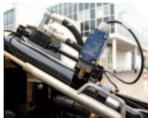
Door het handmatig instellen van een afslag, vindt de chauffeur de maaioogte terug.
