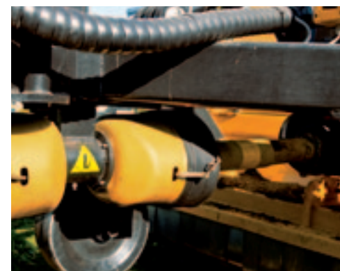
Voor een korte aftaktussenas monteert Omarv een overbrenging onder de dissel.
