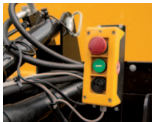
Je moet de trekker uit om de elektrohydraulische functies te activeren.
