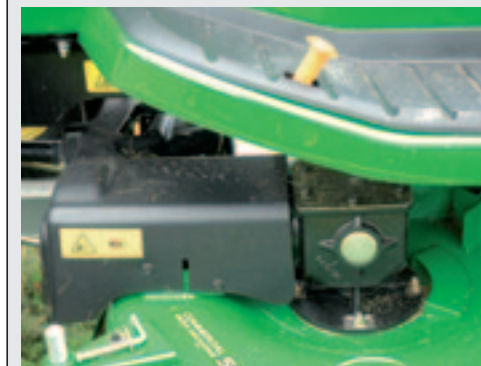
Aandrijving van het maaidek gebeurt met een cardanas en een haakse overbrenging.
