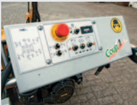
Het inschakelen van de messen en het fijnafstellen van de arm, doe je op het paneel.
