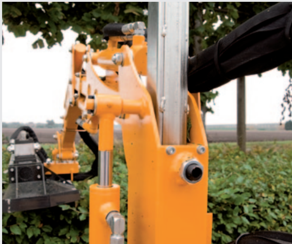
Het eerste armdeel heeft geen draaipunten, zo heeft Coup Eco het telescopisch kunnen maken. Door de extra cilinders op het tweede en derde armdeel, kan de snoeiunit een grote hoek maken.
