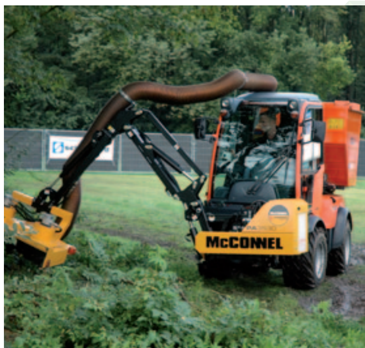
De Vor in Achterveld claimt als importeur van Holder met deze maai-/zuigcombinatie op basis van een Holder C250 de smalste zelfrijder van Nederland in het programma te hebben. In transportpositie is die slechts 140 cm breed. Voorop zit een McConnell PA 3530 (importeur Dabekausen); de kiepbare verzamelbak achterop is van Stoll.
