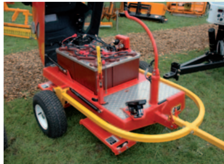
Een mooi voorbeeld van overschakelen van benzine- naar accukracht is deze 'greenroller' van Tru-Turf. Op de green worden de transportwielen opgetrokken en de gele trekboom verwijderd. De 'roller' drukt dan overdwars heen- en weergaand de zode aan. De chauffeur zit haaks op de rijrichting en kijkt afwisselend over de linker- of de rechterschouder.
