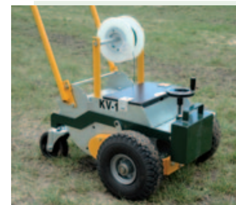
Kabelleggers zoals deze KV-1 van Bonenkamp, zijn nodig om de grenskabels voor robotmaaiers in de grond te leggen. Een mes snijdt een sleuf in de zode, waarna een kouter de snede iets uit elkaar drukt en de draad erin legt. Het loopwielje aan de achterzijde drukt het voortje weer dicht. De werkdiepte is instelbaar tot maximaal 50 mm. De snelheid is traploos regelbaar van 0,6 tot 4 km/h, zowel voor- als achteruit. De KV-1 weegt zonder het ballastgewicht 92 kg en krijgt bij Bonenkamp een nettoverkoopprijs mee van 3.590 euro exclusief btw.
