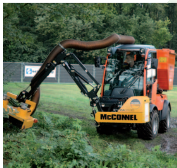
De Vor in Achterveld claimt als importeur van Holder met deze maai-/zuigcombinatie op basis van een Holder C250 de smalste zelfrijder van Nederland in het programma te hebben. In transportpositie is die slechts 140 cm breed. Voorop zit een McConel PA 3530 (importeur Dabekausen); de kiepbare verzamelbak achterop is van Stoll.
