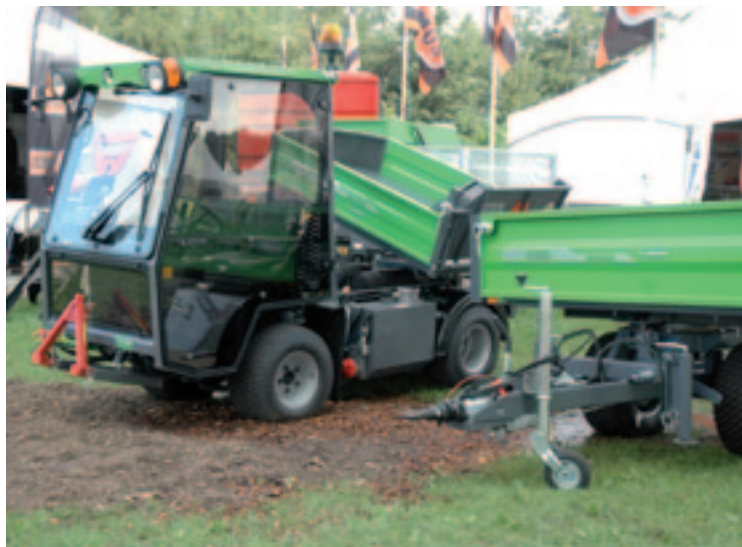
De populariteit van elektrische transporters en/of werktuigendragers zoals deze Mi-Nitrac van Nimos, neemt nog steeds toe. Geen lawaai en uitlaatgassen zijn de belangrijkste plussen. Deze 1.4 E heeft 19,2 kW vermogen. Dat haalt deze Nimos uit acht accu's met 48 volt en een capaciteit van 400 Ah. Het eigen gewicht van deze transporter is 1.700 kg en het laadvermogen bedraagt 1.400 kg.
