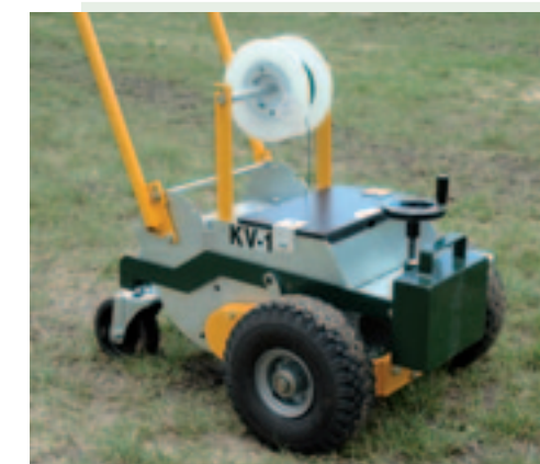
Kabelleggers zoals deze KV-1 van Bonenkamp, zijn nodig om de grenskabels voor robotmaaier in de grond te leggen. Een mes snijdt een sleuf in de zode, waarna een kouter de snede iets uit elkaar drukt en de draad erin legt. Het loopwielje aan de achterzijde drukt het voortje weer dicht. De werkdiepte is instelbaar tot maximaal 50 mm. De snelheid is traploos regelbaar van 0,6 tot 4 km/h, zowel voor- als achteruit. De KV-1 weegt zonder het ballastgewicht 92 kg en krijgt bij Bonenkamp een nettoverkoopprijs mee van 3.590 euro exclusief btw.
