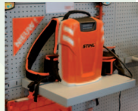
De effectieve werktijd van een elektrisch handwerktuig wordt bepaald door de grootte van de accu. Stihl omzeilt dat probleem met de ruggedragen accu die de werkduur tot een veelvoud laat oplopen van de standaard-accu aan of in de machine. Voorwaarde is wel dat het werk grotendeels rechtopstaand kan gebeuren, omdat anders het gewicht op de rug toch wel fors doordrukt. Ook is het zaak dat je niet te veel tussen ruigte moet doorlopen, omdat anders het snoer nog wel eens blijft haken.
