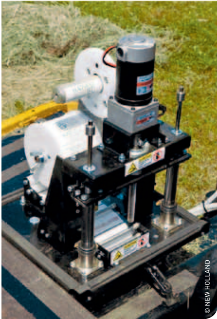
Bij grootpakpersen uitgerust met het Crop ID-systeem wordt bij het aanbrengen van de tweede knoop rond de baal ook een 'leeg' label aangebracht.
