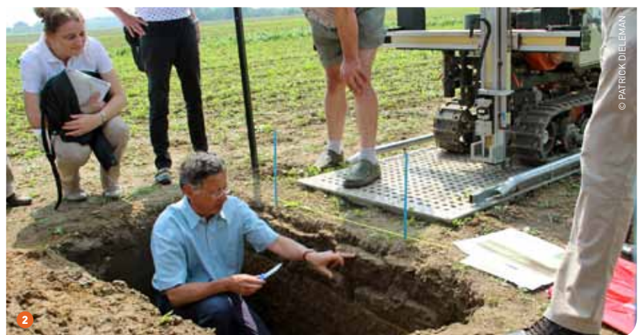
1 De Evers Forest met smalle stekende beiteltanden wordt veel toegepast in Nederlands Limburg om bodemverdichting op te heffen. 2 Christian Roisin van het CRA-W in Gembloux toonde hoe ook niet-kerende grondbewerking aanleiding kan geven tot de vorming van ploegzolen. Bemerkt de penetrometer op de achtergrond.
