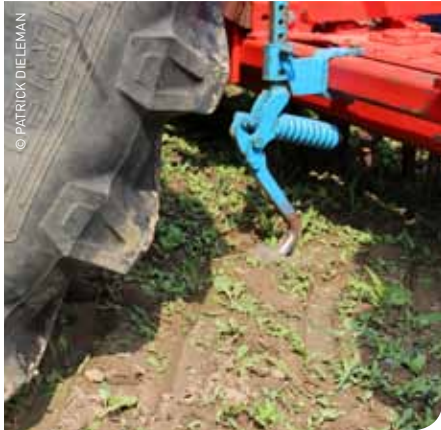
Omdat wielsporen aanleiding kunnen geven tot geulerosie kan het nuttig zijn om een sporenwisser te monteren.
