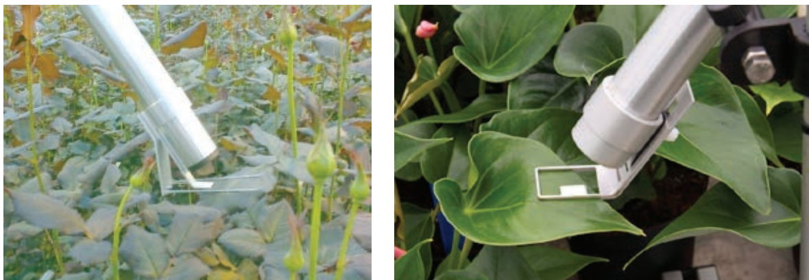
Figuur 3. Metingen met een Plantivity meter aan verschillende gewassen in de kas.
