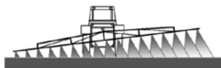
Figuur 2 Pendelen van de spuitboom en het effect op de verdeling in het veld - Bron: ILVO
