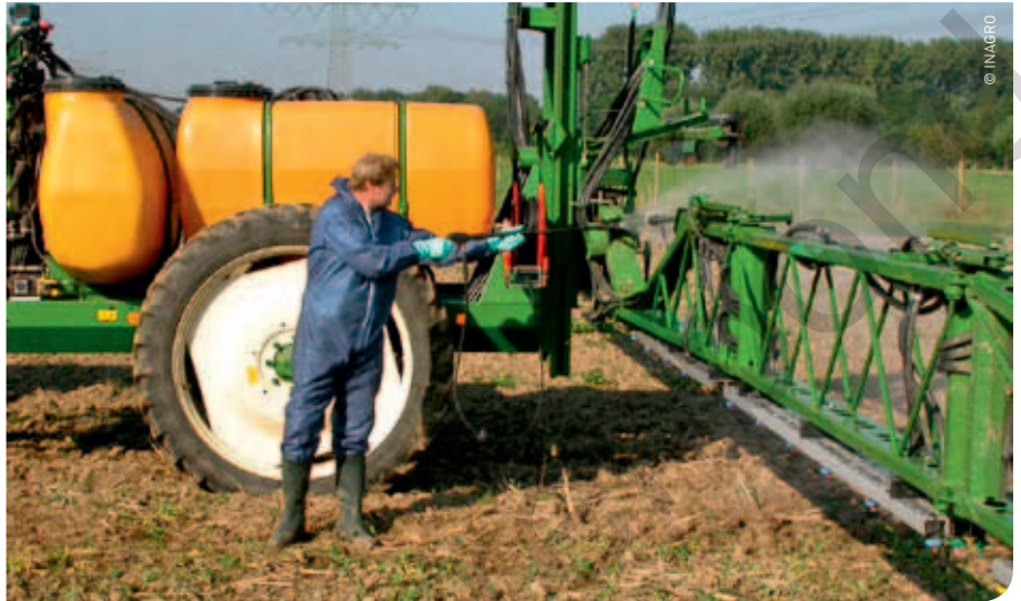
Reinig het spuittoestel uitwendig in het veld of op een verharde vul- en spoelplaats met opvang voor het restwater.
