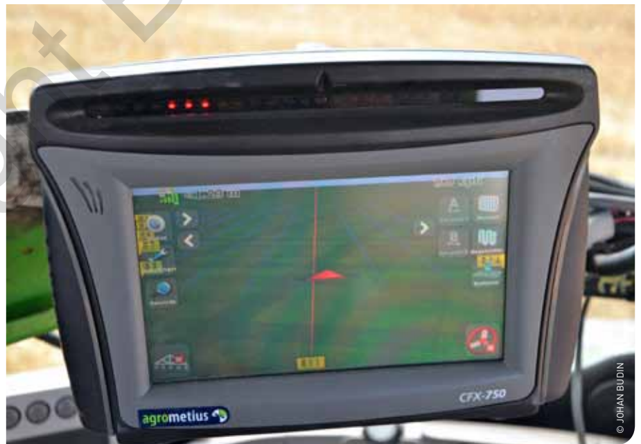
Stuurgeleiding, met bovenaan de lichtbalk en onderaan het geleidingspatroon: een rechte AB-lijn. Op het scherm is te zien dat de machine 1,23 m afwijkt van werkgang R11. Dit is het systeem Trimble CFX-750.
