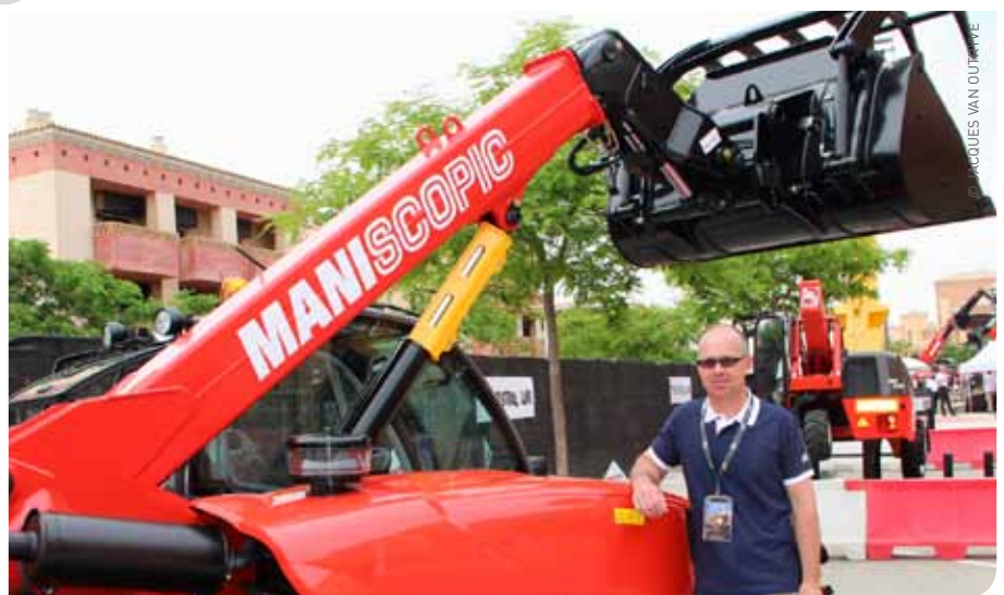
Wim Roose van Manitou bij de MLT 625, een supercompacte verreiker die met een breedte van 180 cm zowat overal door en bij kan.
