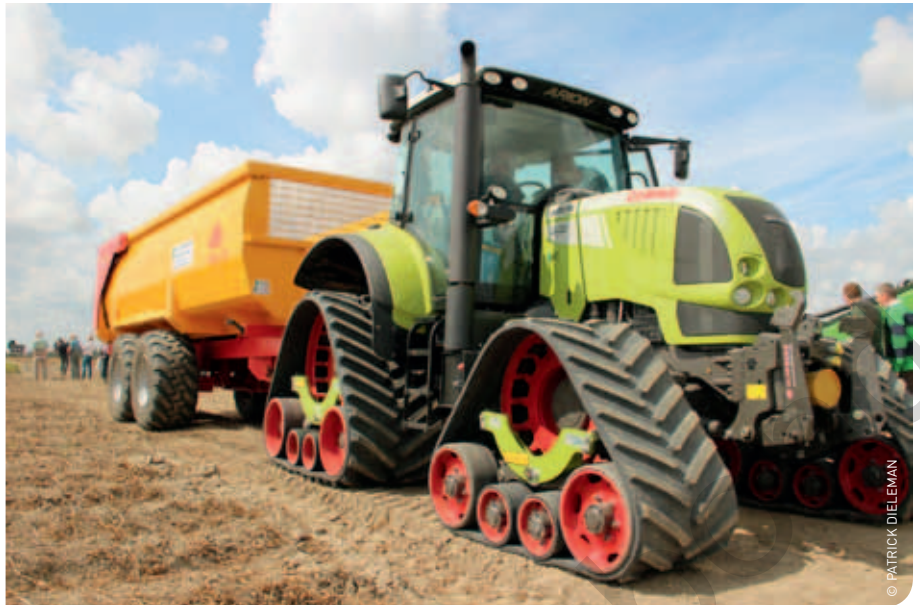
De trekkers die de aardappelen van de rooidemonstraties afvoerden, toonden hoe je met rupsbanden bodemverdichting kan voorkomen.
