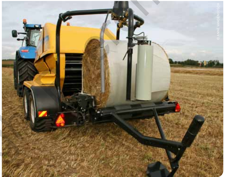
Met de 2 topmodellen Roll Baler 125 Combi en 135 Ultra kan je in één beweging persen en wikkelen, bovendien kan je kiezen tussen netbinding of foliewikkeling.
