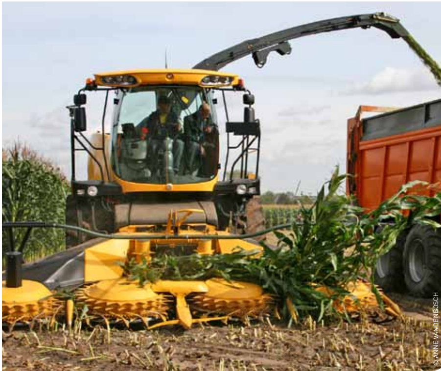
De nieuwe FR-hakselaar aan het werk. Dankzij de IntelliFill-technologie wordt de aanhanger ernaast feilloos gevuld.
