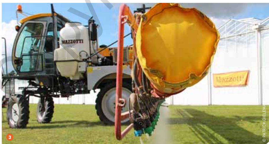
1 De Qii-jet TAH300 rijdt automatisch tot het einde van het pad. 2 De door Halters Agri Techniek getoonde spuit kan 2 en 2 halve rijen in één keer behandelen. 3 Bij deze op een Mazzotti opgebouwde luchtondersteunde spuit kan je met een druk op de knop van doppen wisselen.
