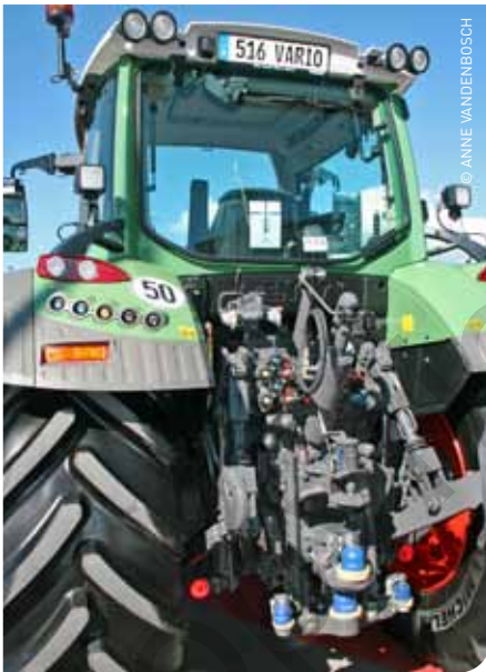
De 500 Vario beschikt over niet minder dan 22 aansluitingen voor olie, stroom, perslucht, data-connectoren ...
