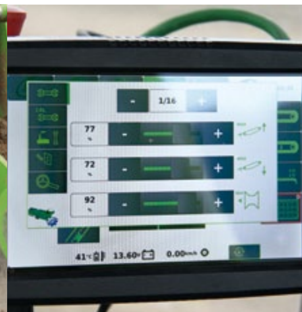
▲ De toerentallen van verschillende matten zijn traploos (in procenten) in te stellen.
