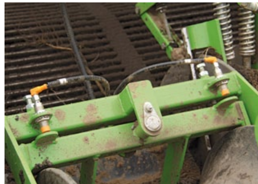
▲ Twee sensoren op de diabolo registreren de positie van de rooibek en sturen de knikdissel aan.
