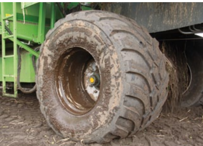
▲ De maximale bandenmaat is 850/50R30.5. Hydraulische wielaandrijving is een must bij de oogst onder natte omstandigheden.
