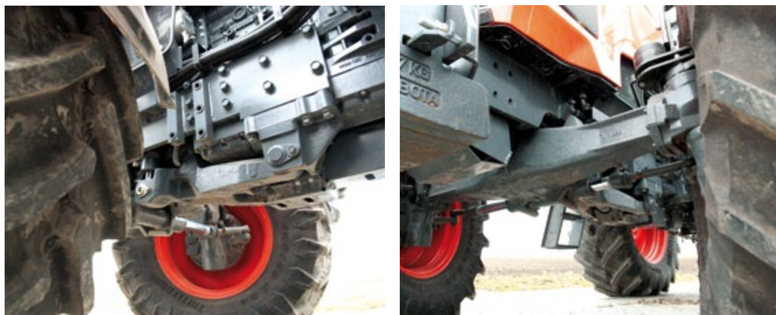
Door de twee haakse overbrengingen en de as daartussen liggen de wielassen bij de Kubota lager dan de vooras en ontstaat een grotere bodemvrijheid.
