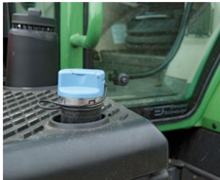
▲ De AdBlue-tank heeft een inhoud van 38 liter; de dieseltank meet 400 liter. De doppen van de tanks hebben elk een aparte sleutel. Logisch met het oog op diefstal, maar voor de dagelijkse praktijk niet handig.
