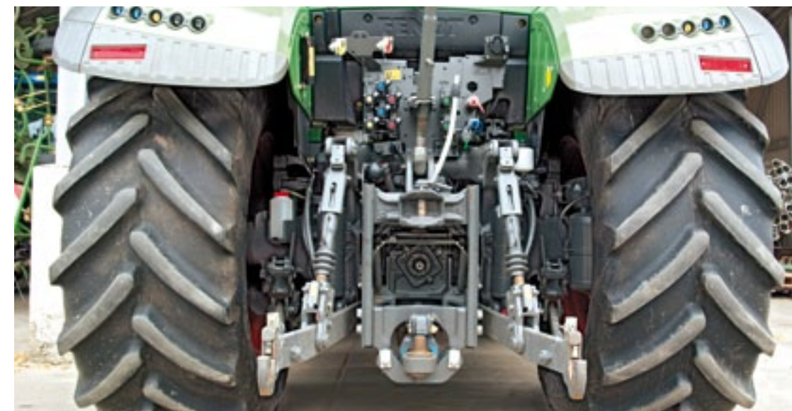
De hefkraft bedraagt ruim 10,5 ton. Hef, aftakas en één DW-ventiel zijn vanaf het spatbord te bedienen.
