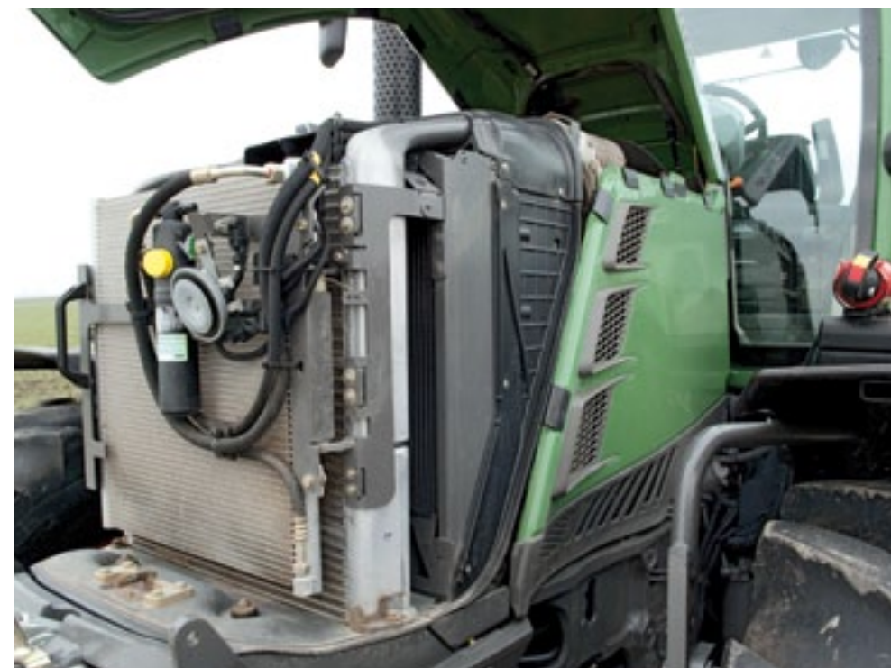
▲ De zijplaten gaan niet met de motorkap mee omhoog. Bovendien zijn ze vrij zwaar, waardoor het lastig is om ze in je eentje te verwijderen. De koelers in de neus van de trekker zijn daarentegen goed bereikbaar en ook goed te reinigen.
