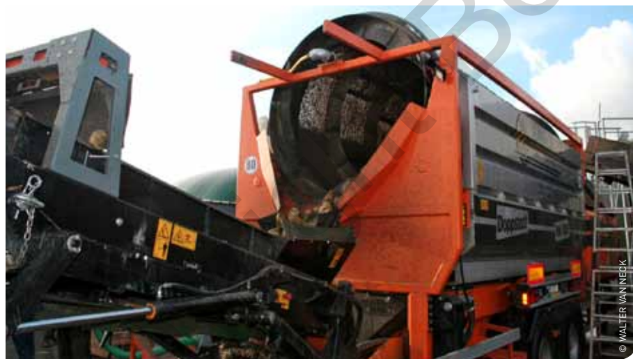
In de RW 508 bietenwasser van Doppstadt worden de laatste restjes zand van de bieten gewassen. Zand belemmert het optimaal functioneren van de vergister. Het spelwater wordt opgevangen en opnieuw gebruikt.
