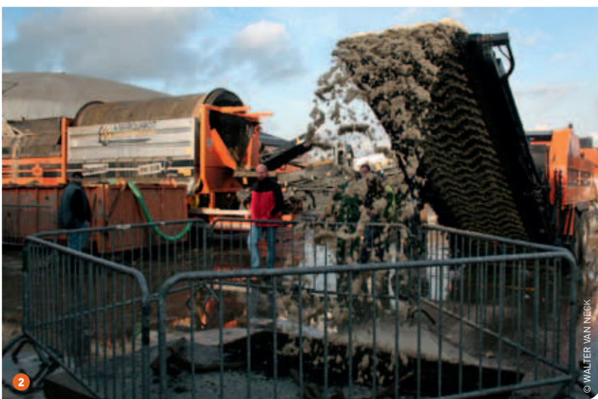
1 Via een lopende band belanden de bieten in de shredder, de AK-230 Doppstadt, die ze tot pulp vermaakt. De pulp wordt in kelders opgeslagen. 2 Algemene opstelling: rechts wordt de grove ballast gezeefd (ontstener), in het midden zie je de waslijn en rechts de shredder (vermaler).
