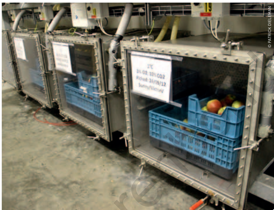
De bewaarproeven gebeuren in kleine koelcontainers.
