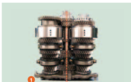
Figuur 1 De Direct Drive van John Deere is geplaatst tussen de reversebak (voor- en achteruit) en de groepenbak.
