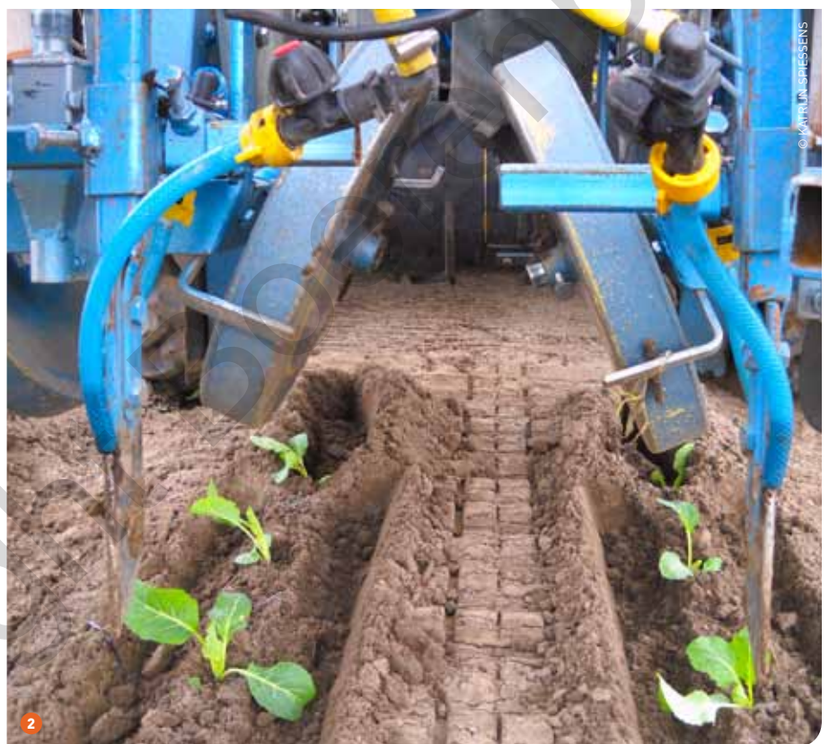
1 De opkweek gebeurt in perspotten in de serre. 2 Een injecteur voor vloeibare meststoffen wordt achteraan op de plantmachine geplaatst.
