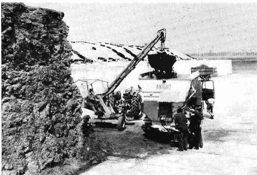
Het uithalen van kuilvoer met grijper en voermengwagen op een groot vleesstierenbedrijf. Voor beoordeling van de afmetingen van de kuilhoop en de silo kunnen de personen als maatstaf dienen.
