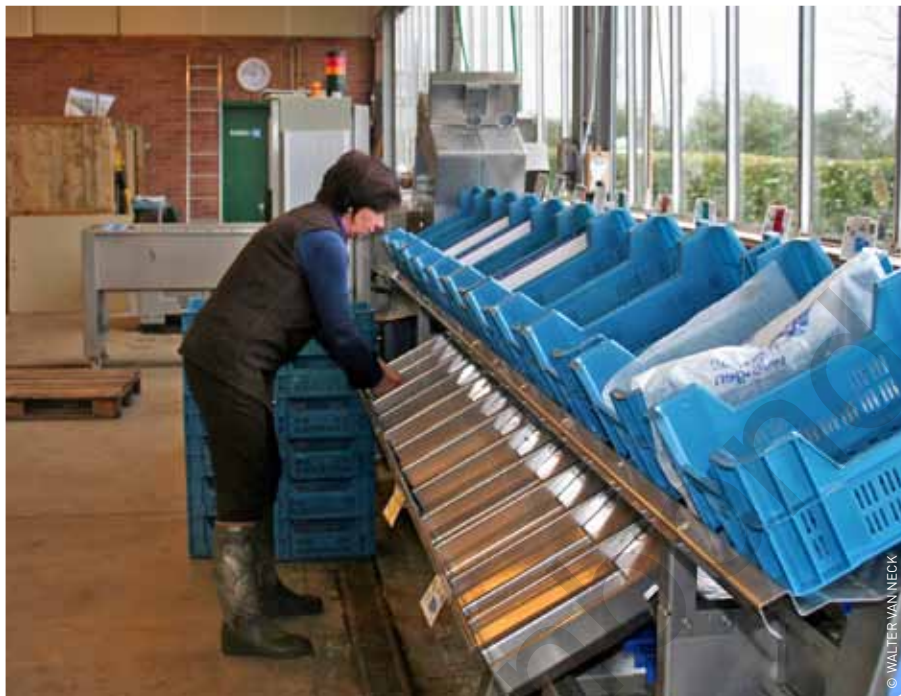
Rekening houdend met alle parameters verdeelt de machine de asperges dus over de 12 uitgangen. De fabrikant kan het aantal uitgangen uitbreiden met een veelvoud van 4.
