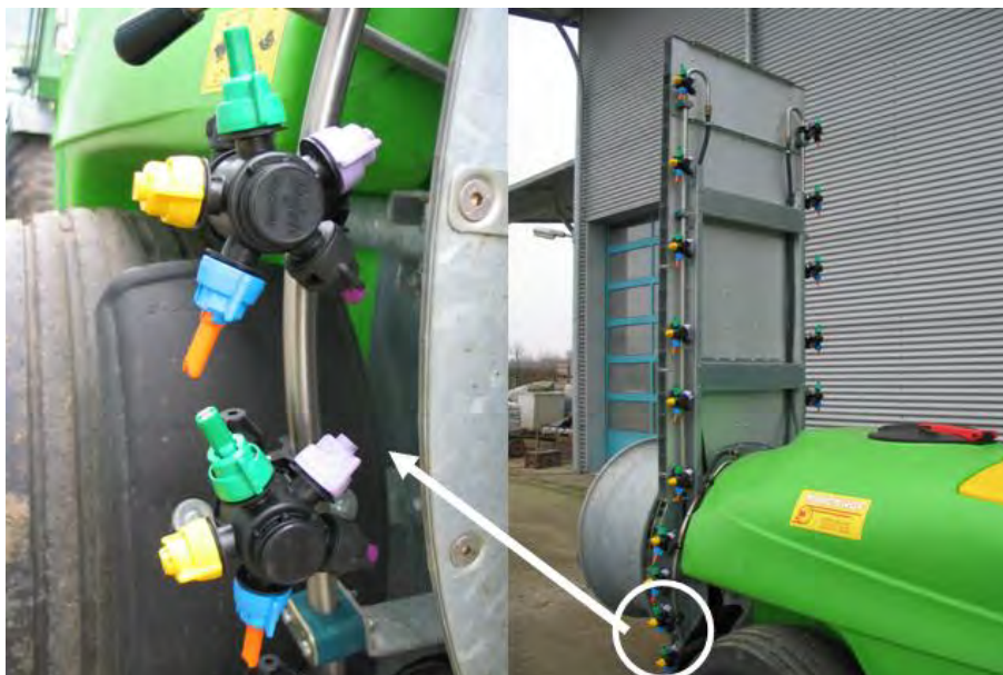
Figuur 2.1. Dwarsstroomspuit met detailopname draaibare dophouders met 5 spuitdoppen waarvan twee (Albuz ATR Lila, Albuz TVI 80.025) werden gebruikt tijdens het veldonderzoek (2011).
