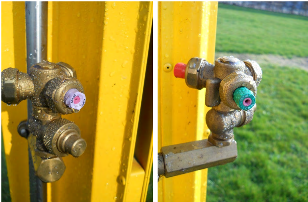
Figuur 2.3. Draaibare dophouders met Albus ATR Lila holle kegel werveldoppen (links) en Albus TVI 80.015 venturi werveldoppen (rechts).
