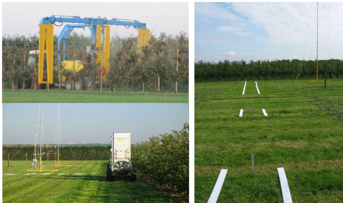
Figuur 2.7. Overzicht drift meetopstelling naast boomgaard en de Munckhof dwarsstroomspuit (links onder) en de KWH drierij (links boven) tijdens de driftmetingen.
