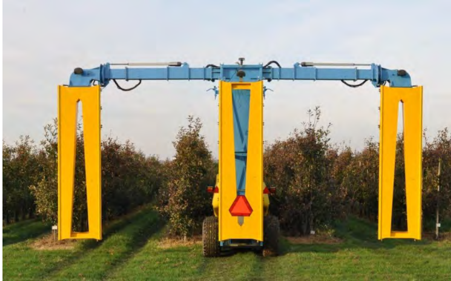
Figuur 2.2. KWH 3 rijer k1500-3R2, uitgerust met het Variabel Lucht Ondersteunings Systeem (VLOS).
