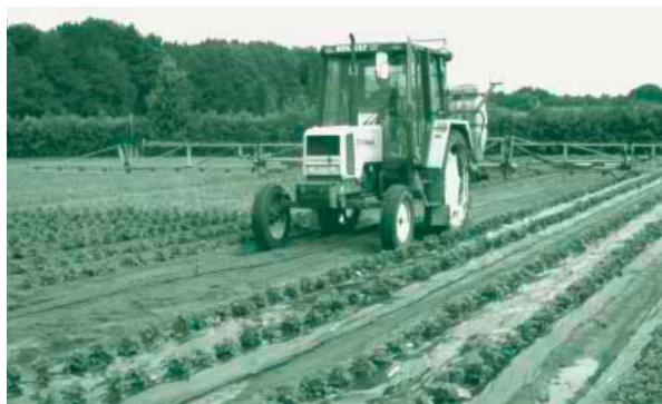
Vóór het leggen van de folie in aardbeien wordt onkruid in de rij bestreden met de vingerwieder. Door het gebruik van folie wordt chemische onkruidbestrijding overbodig
