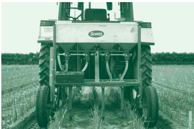
Om langere tijd in de behoefte van het gewas te voorzien en om de uitspoeling te beperken wordt een slow-release meststof gebruikt
