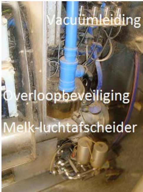
Figuur 6: Melk-luchtafscheider en overloopbeveiliging (robot)
