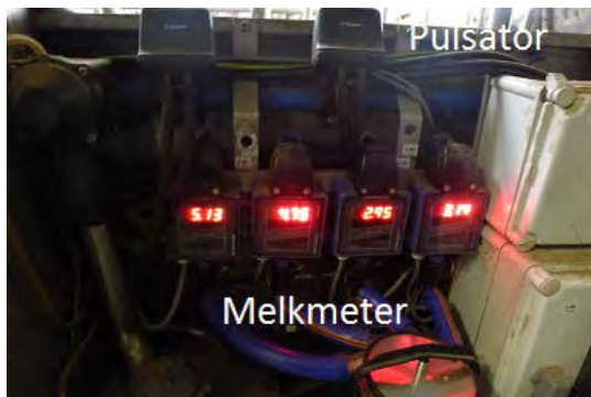
Figuur 10: elektronische melkmeters en pulsator/drukwisselsysteem
