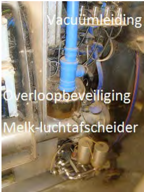
Figuur 6: Melk-luchtafscheider en overloopbeveiliging (robot)
