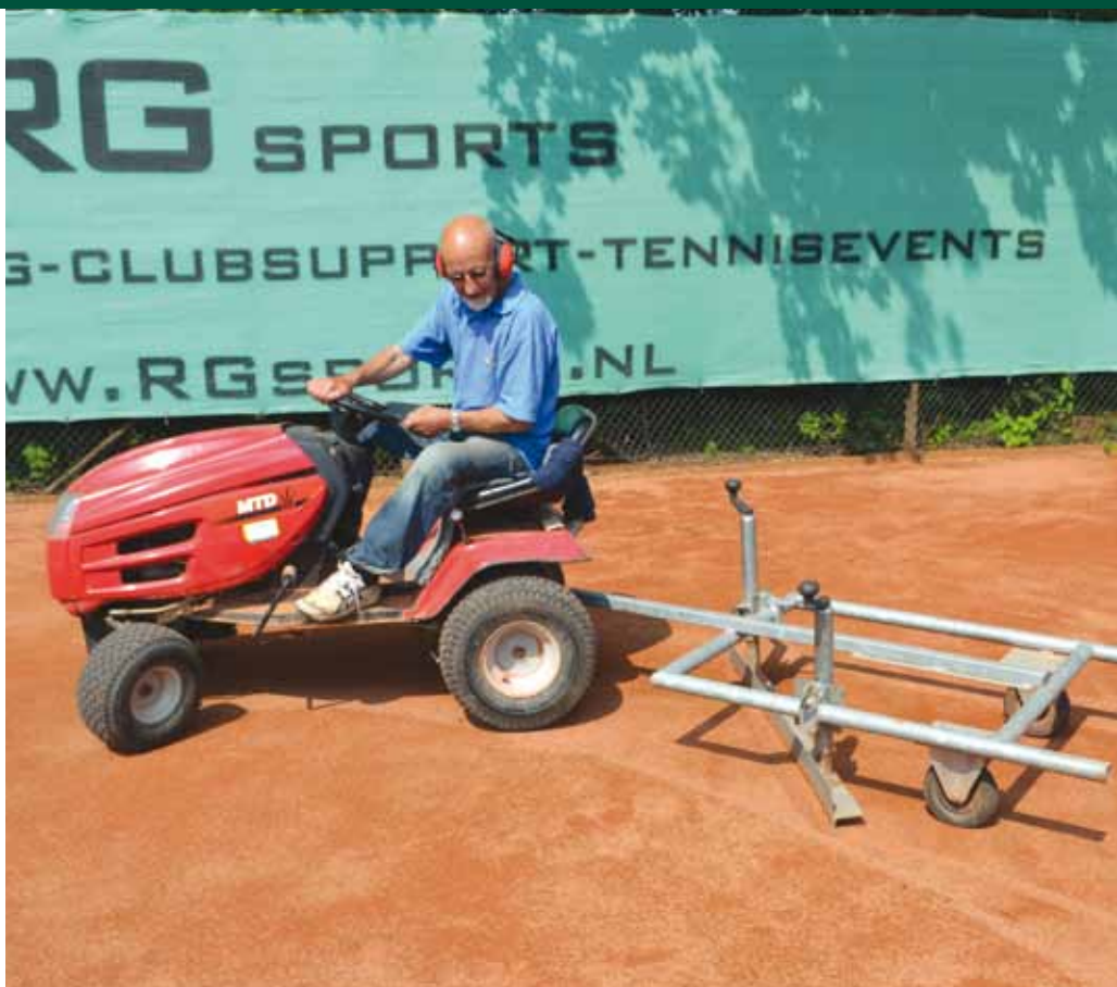
De getrokken schaafmachine die Bavo de arbeid licht maakt.
