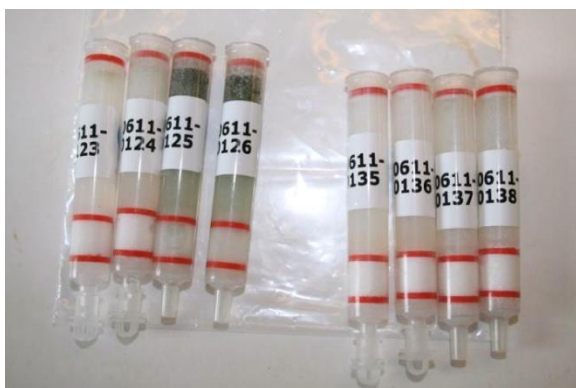
Figuur 3.4: Foto van patronen na 4 dagen plaatsing in doorstroombad bij stroomsnelheid van 0,1 m/s, experiment P094. De linker vier hebben fritted glasfilters en de rechter 4 glasvezelfilters aan de bovenzijde. Per groep van vier zijn de linker 2 (met de dopjes aan de onderkant) afgesloten geweest om te controleren op diffusie.
