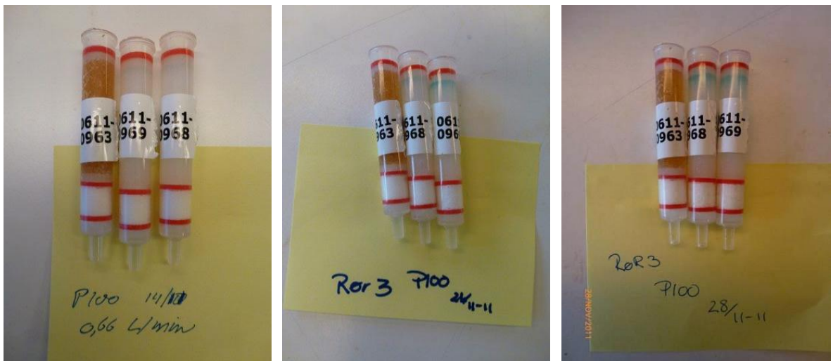
Figuur 3.7: Fotoserie na 1,2 en 3 weken doorstroming (van links naar rechts) van patronen bij plaatsing in drains bij een stroomsnelheid van 1 cm/s, P100
