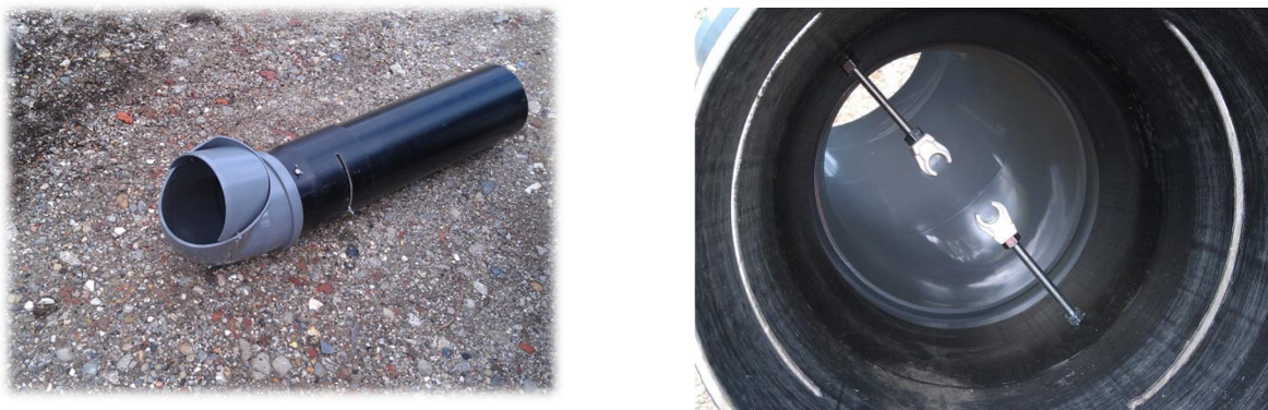
Figuur 2 90 graden opzetstuk met kliksysteem voor SorbiCells op ca. 6 cm van de wand, zoals gebruikt bij het Waterschap Rivierenland
