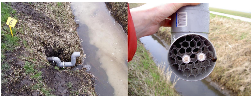
Figuur 4.14 Impressies van eerste test met SorbiCells in spacer op locatie Zeewolde.
