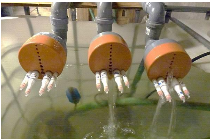
Figuur 3.15: Testen van de Flow-Caps bij verschillende afvoeren
