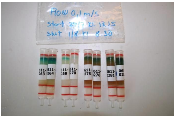
Figuur 3.5: Foto van patronen na 3 dagen plaatsing in doorstroombad bij een stroomsnelheid van 0,1 m/s, experiment P097. De linker 4 SorbiCells zijn NiP- en de rechter 4 CAN-SorbiCells. Van deze 4 hebben de linker 2 een 60—100µm en de rechter 2 een 100-160 glasfilter.
