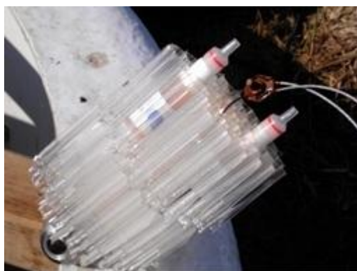
Figuur 4.10 SorbiCells in spacer zoals geïnstalleerd op locatie Rusthoeve.
