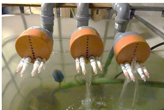
Figuur S2: Testen van de Flow-Caps bij verschillende afvoeren
