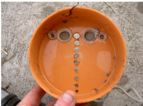
Figuur 4.16: Flow-Caps na de installatieperiode van 30 november tot 11 januari; geen verstopping, wel wat grassprietjes (links), goed verkleurde adsorptiereservoirs en ruime hoeveelheden zout verdwenen in de SorbiCells (rechts).
