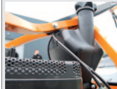
De tank is aan het frame bevestigd en is zo eenvoudig te demonteren.
