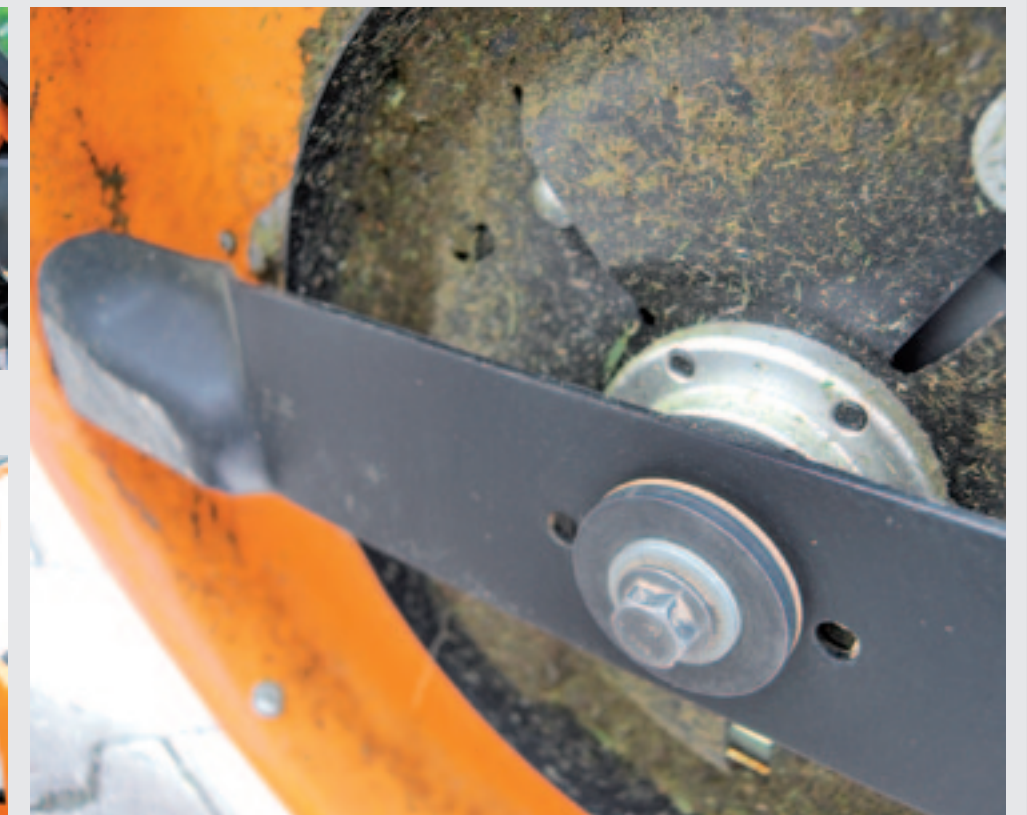
De krukas is driedubbel gelagerd: in de motor, in de behuizing en bij de mesbevestiging. Dit laatste lager moet schade aan de krukas voorkomen bij een aanrijding met een steen of iets dergelijks.
