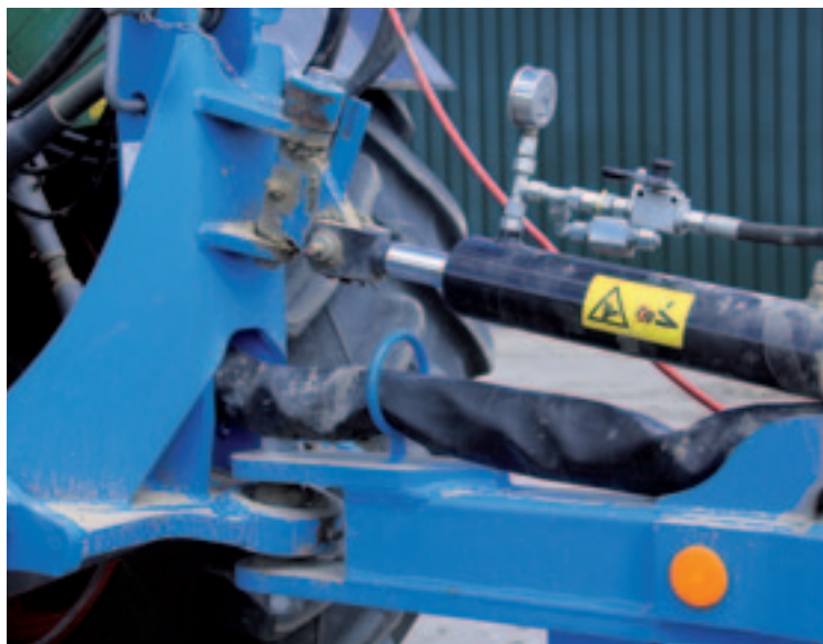
▲ Uniek bij de getrokken modellen is deze top-trekcilinder. Hiermee wordt extra gewicht op de achteras overgebracht.
