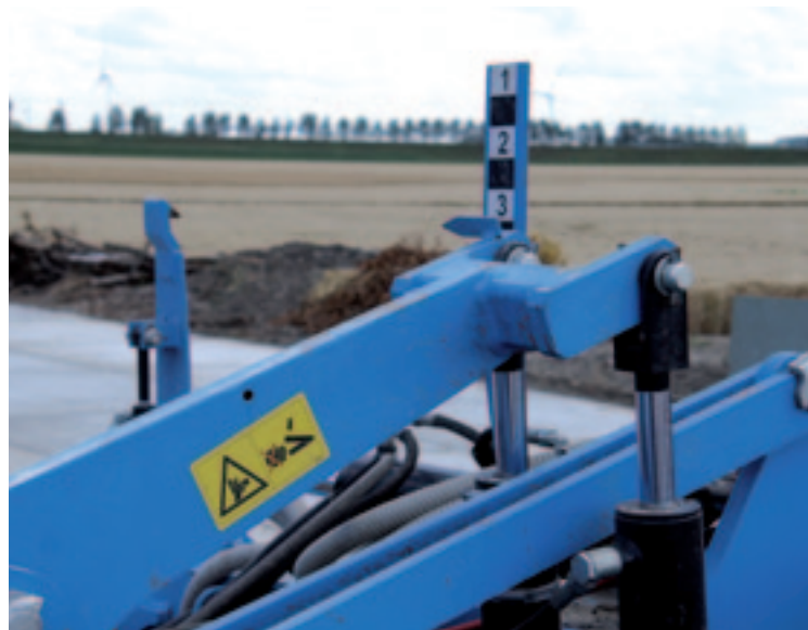
▲ Om de machine voor en achter gelijk in diepte te verstellen, zakken (of heffen) voor- en achterzijde tegelijk. De diepte lees je af op een wijzer.
