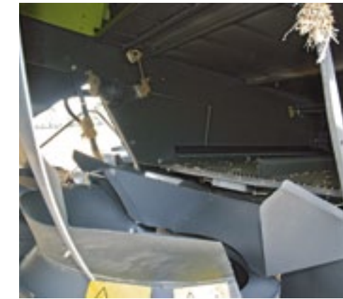
▲ Op de zeven zitten verschillende sensoren die stand van de zeven weergeven.
