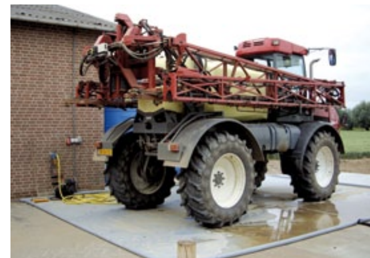
▲ Een flexibele en verplaatsbare reinigingsplaats voor het uitwendig reinigen van de spuit is er in verschillende afmetingen.
