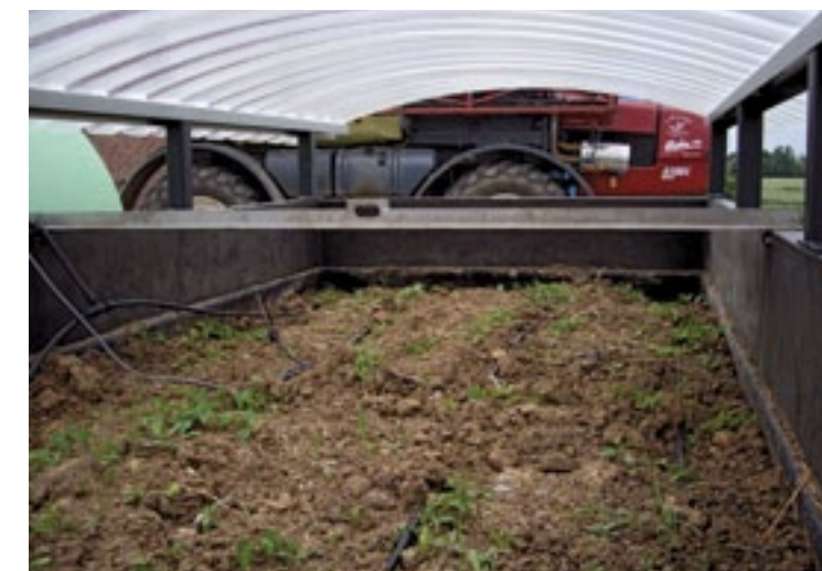
▲ Een biofilter bestaat uit een met stro, compost en grond gevulde bak, waarbij micro-organismen de middelen uit het reinigingswater afbreken.
