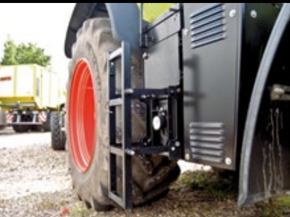
▲ Via deze uitklapbare trap kom je makkelijk bij de ruitenwisser en de rechter werkklampen.
