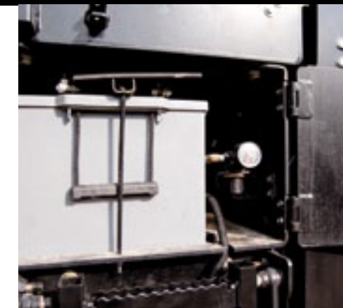
▲ Naast de accu zit de draaiknop om de luchttoevoer naar de aanhangerrrem te smoren.
