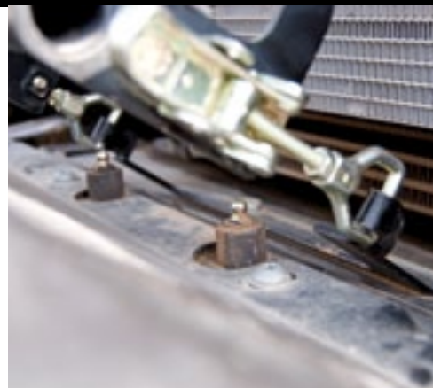
▲ Dankzij deze twee vetnippels hoef je jezelf niet op de rug te leggen om de vooras te smeren.
