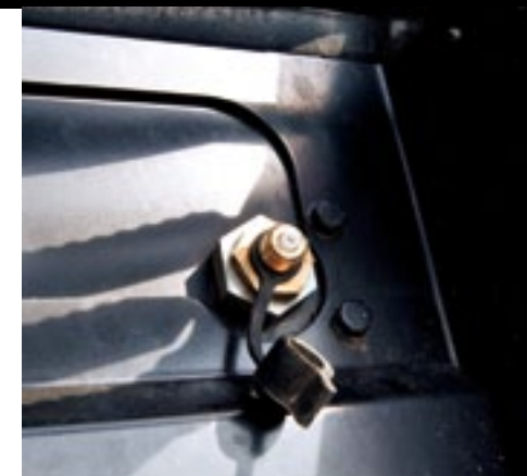
▲ Een koppeling voor een luchtpistool zit achter de cabinetrap. Handig voor het schoonblazen.
