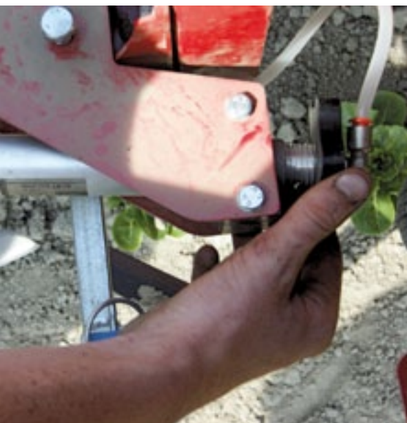
▲ Met behulp van een verstelknop kan de in- en uitgaande slag van de schoffelmessen worden ingesteld.
