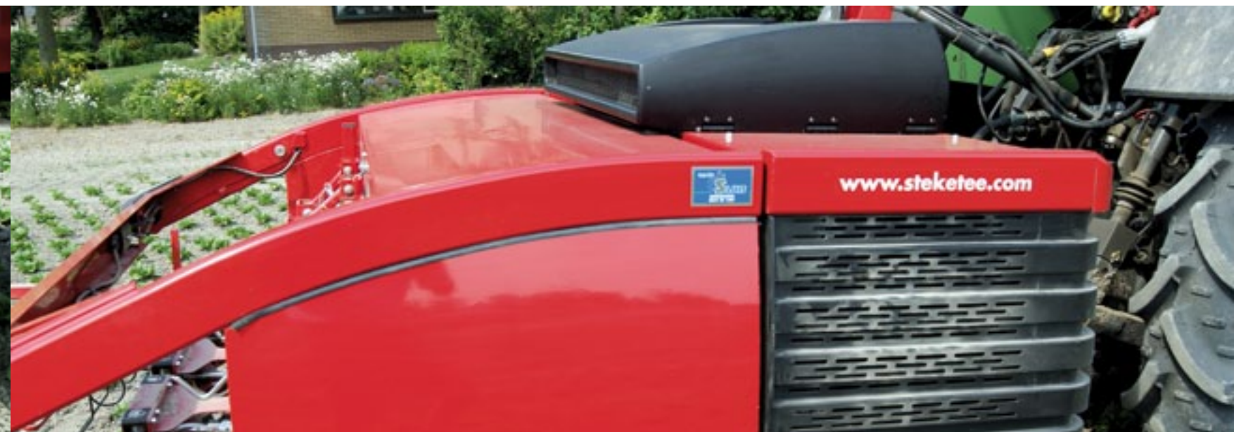
▲ De zijkanten zijn netjes afgewerkt. Achter het zwarte rooster zit de oliekoeler. Bovenop de machine heeft de computer met de compressor een plekje gekregen.
