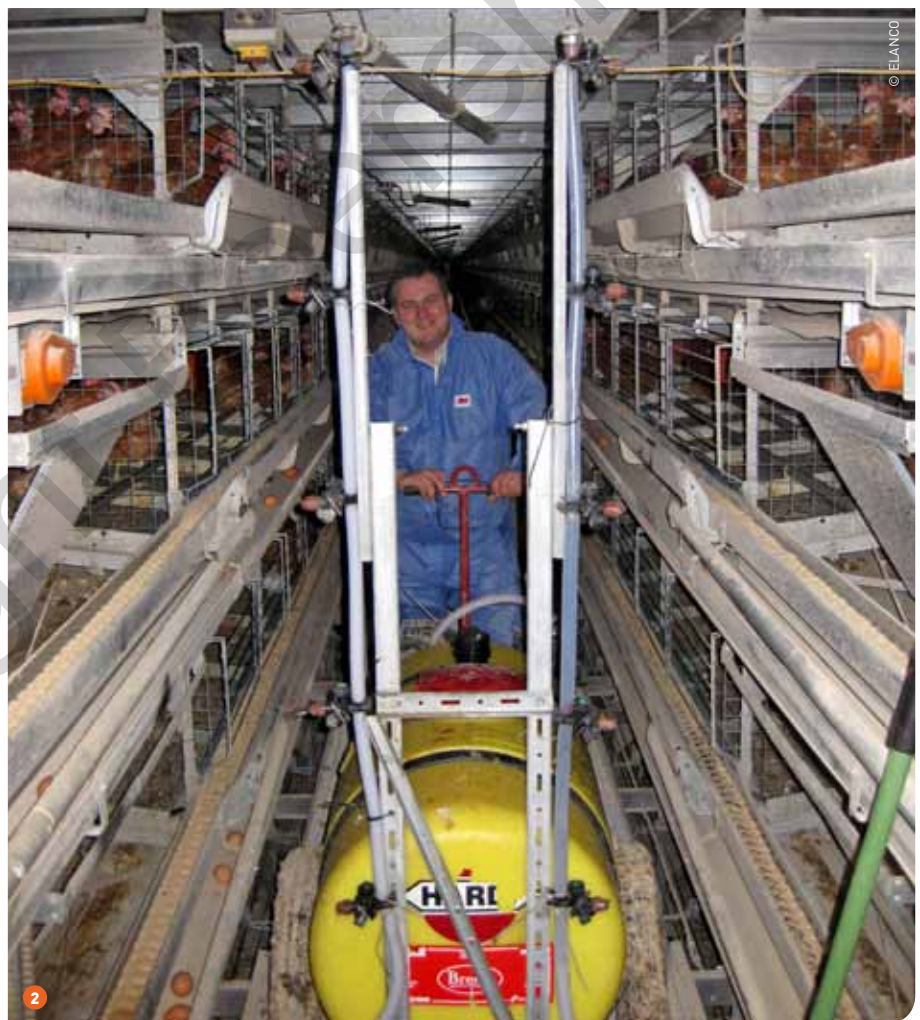
1 In zwaar besmette stallen vervuilen bloedluizen de eieren. 2 Pluimveehouders kunnen het bloedluismiddel eenvoudig toedienen met een sproeiwagen.
