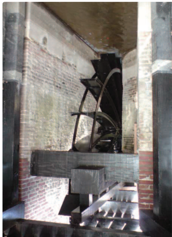
Door het lage toerental van poldermolens is de overlevingskans van passerende vissen groter.
