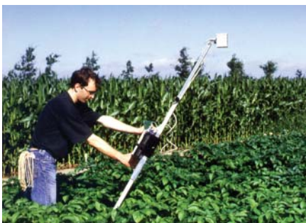
Bepaling van de stikstofstatus van het gewas met de CropScan
