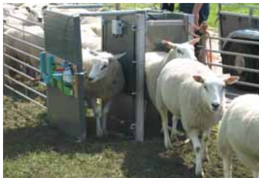
Figuur 14 De schapen hebben twee doorgangen met meervoudige zendontvangers
