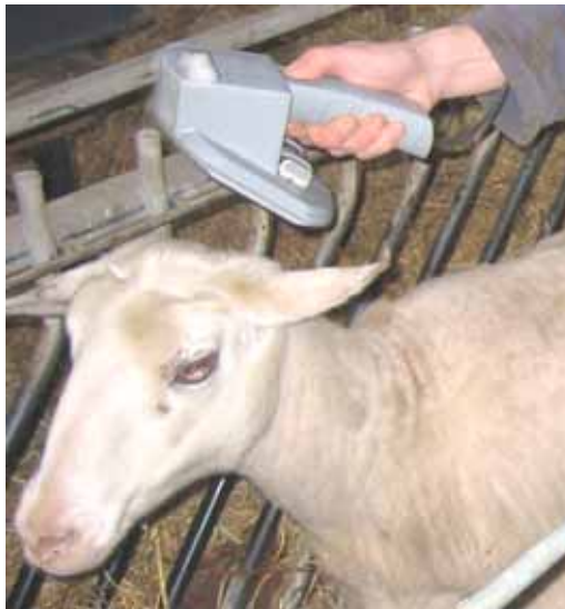
Figuur 10 Uitlezen identificatie code van oormerk met handheld zendontvanger
